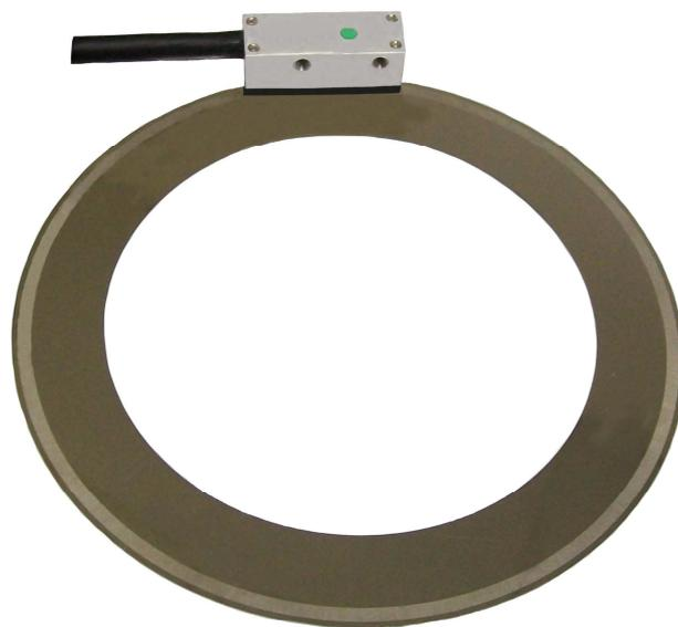
英诺伺服 **Microlin** 敞开式圆光栅角位移传感器采用非接触反射式设计，用来做精确的角位置反馈。该编码器系统采用高耐蚀、高反射率的特种不锈钢码盘作为系统的标尺。能够输出符合工业标准的增量 (A quad B) 数字方波型号或者模拟正弦信号。独特的设计使 **Microlin** 系列敞开式圆光栅角位移编码器有比传统角位移编码器更加突出的性能和更好的稳定性。
