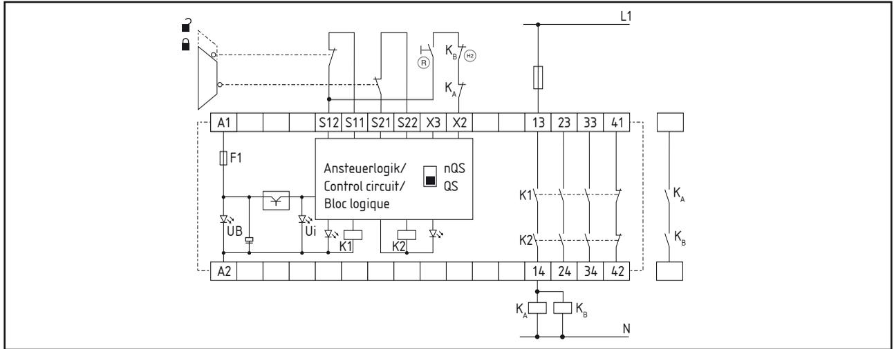
Zweikanalige Ansteuerung, dargestellt am Beispiel einer Schutztürüberwachung mit zwei Positionsschaltern, davon einem zwangsöffnend und externem Resettaster (R).
