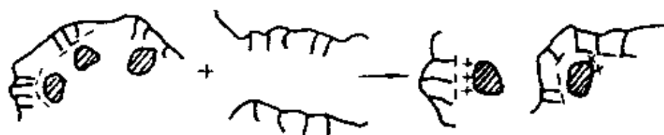
图 7-19 凝聚与分散作用示意图
