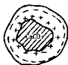
图 7-17 晶体微粒双电层示意图
