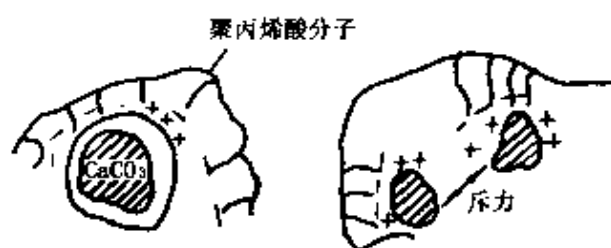
图 7-18 晶体之间的静电斥力示意图
