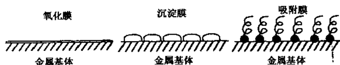
图 4-34 冷却水中缓蚀剂成膜形式图示
