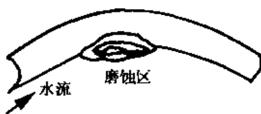
图 4-29 弯管磨蚀示意图
