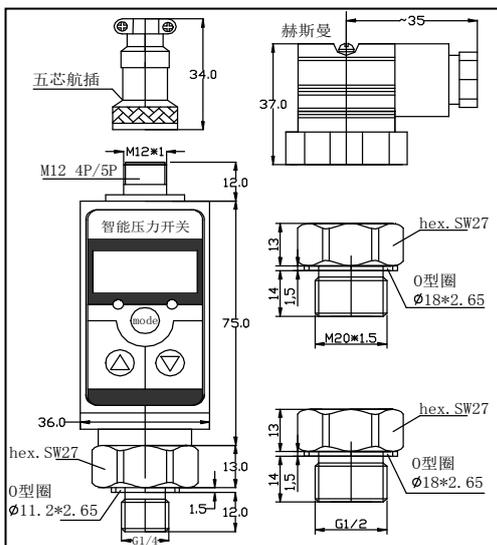
注：开关点由吸合值和释放值组态决定，吸合值大于释放值时为上限报警输出（常开功能），吸合值小于释放值时为下限报警输出（常闭功能）吸合值与释放值的差值为开关点的回差。
